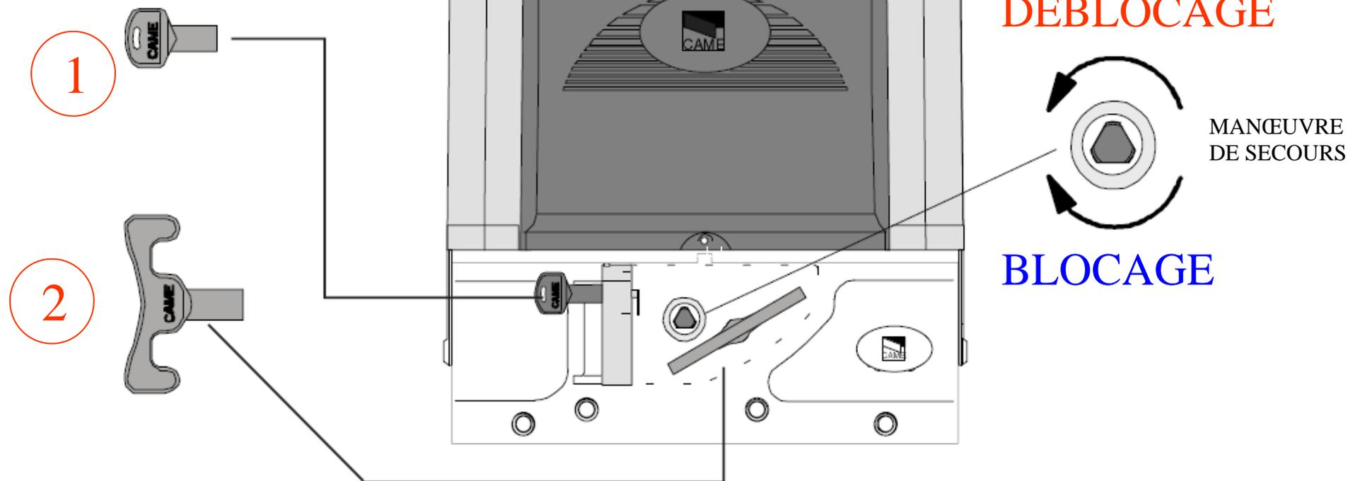
2/ AVEC LA GROSSE CLE, ACTIONNER LA MANŒUVRE DE SECOURS DANS LE SENS DE DEBLOCAGE (jusqu'à sentir un léger déclenchement).
