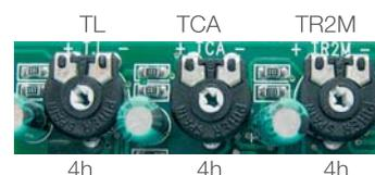
A la fin de l'installation, régler finement les Trimmers (P 3)
