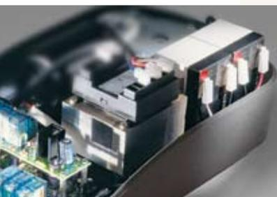
**Une efficacité optimale.** Un automatisme en 24V qui ouvre toujours votre garage, même en cas de panne, grâce aux batteries de secours internes (en option).
