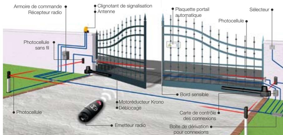
L'utilisation des bords de sécurité à rayon infrarouge ou à contact mécanique est indispensable au cas où l'analyse des risques le préconise.
