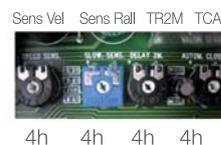
A la fin de l'installation, régler finement les Trimmers (P 3)
