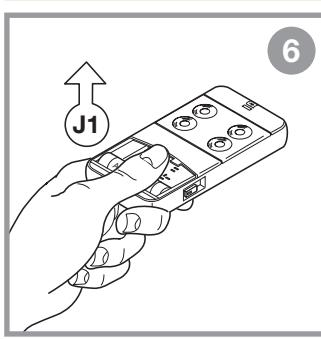
**CAMBIO BATTERIE - CHANGING THE BATTERY - REMplacement DE BATTERIE - BATTERIEWECHSEL - SUSTITUCIÓN DE LA PILA**
