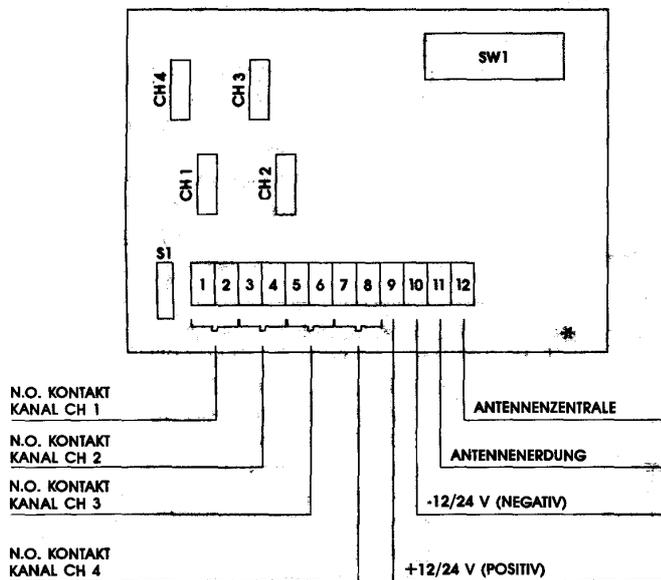
DER KANAL CH 1 ENTSpricht DER ERSTEN TASTE DER SENDER.
